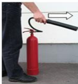
Cev usmerimo proti požaru
