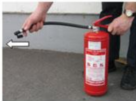
Cev usmerimo proti požaru
